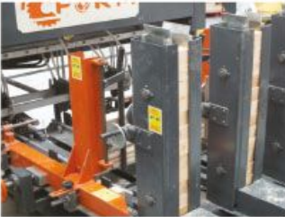
Block magazine for automatic feeding Takoza ölçüsüne göre ayarlanabilir şarjör
