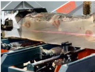
Laser sight for cutting line Kesim çizgisi için lazer
