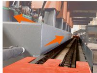
Return conveyor Latanın tekrar işleme girmesi için geri dönüş bandı
